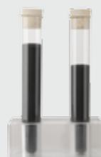
Для изготовления EcoKnife требуется меньше вольфрама и кобальта. Слева: Расход порошка на изготовление стандартной поворотной пластины. Справа: Расход порошка на изготовление EcoKnife
