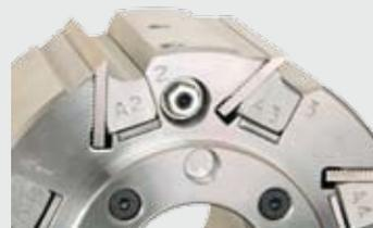
Простота в обращении и отличная балансировка благодаря нумерации прижимных планок и соответствующих каналов для отвода стружки
